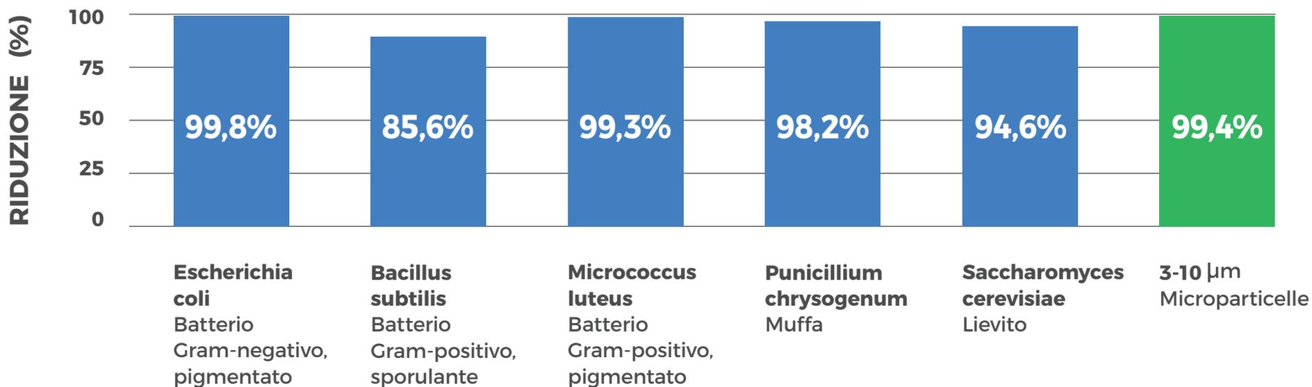
● Risultati dei test di rimozione degli organismi/batteri dopo il trattamento con AERO 750. Numero di test per organismo = 3.
